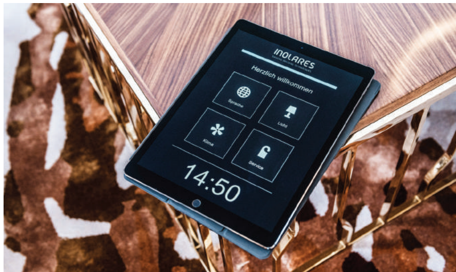
▲ Das webbasierte System vereint die Regelung der gesamten Zimmertechnik – von der Klimaanlage und Heizung bis zur Beleuchtung.
